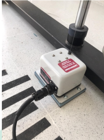
Figura 1. Fotografía del ENCODER lineal: T-FORCE. (Fuente: Elaboración propia)
