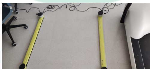
Figura 3. Fotografía de la plataforma de salto OPTOJUMP. (Fuente: Elaboración propia)
